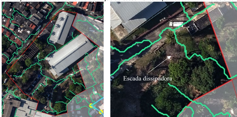
Figura 4 - Identificação de muretas desviando a direção do escoamento superficial com auxílio de ortoimagem.
