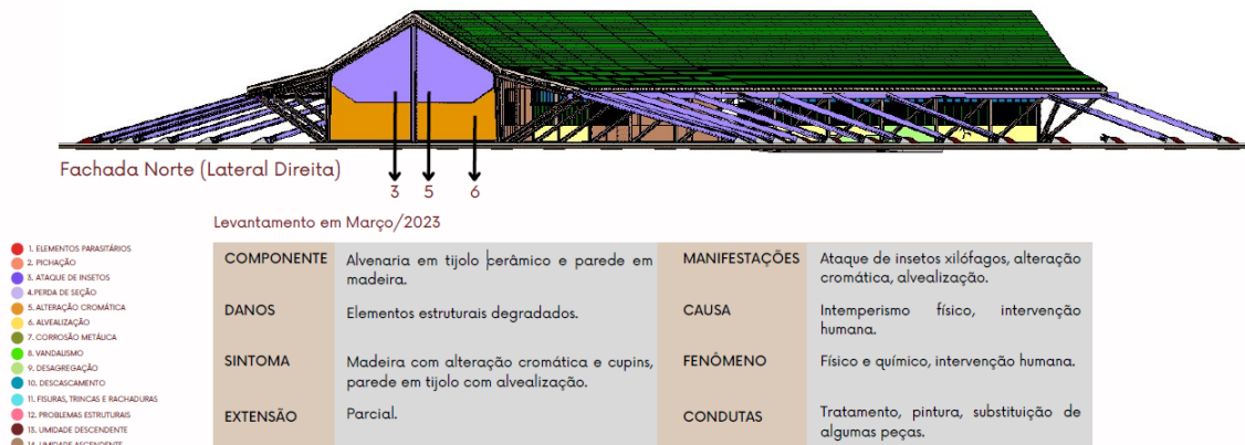
Figura 6 – Danos inseridos no modelo virtual do MIRR
