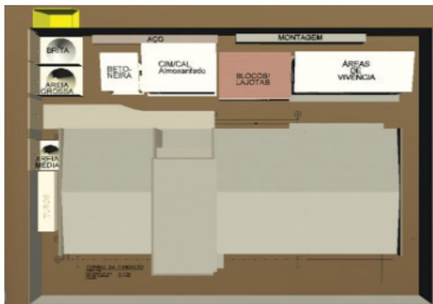
Figura 6a – Canteiro de Obra Modelado 3D
