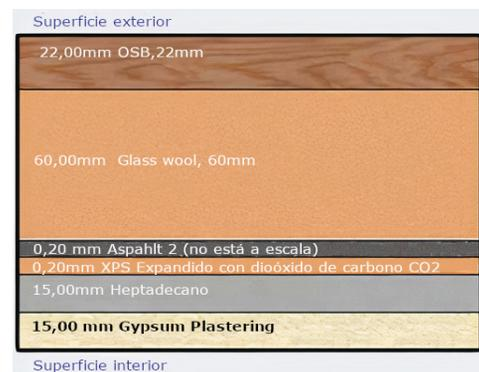
Figura 3.2 - Configuración del muro exterior con heptadecano.
