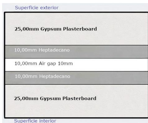
Figura 3.3 Configuración de la partición con heptadecano.
