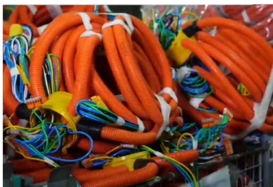
Figura 10 – Conduítes com toda fiação embutida
