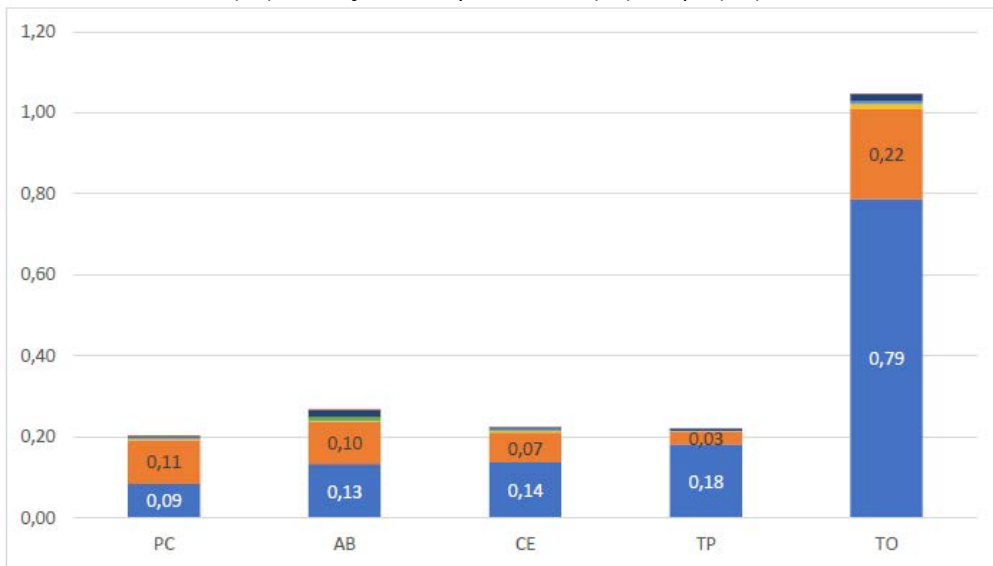
Figura 5: Gráfico do FD médio por região da fachada - paredes contínuas (PC), aberturas (AB), cantos e extremidades (CE), transição entre pavimentos (TP) e topo (TO).
