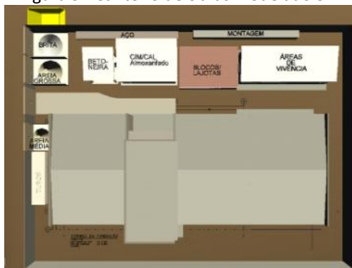
Figura 5 - Canteiro de obras modelado 3D.
