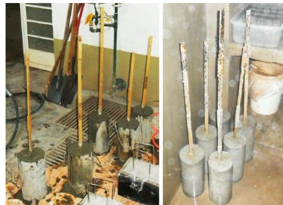
Figura 2 – Elaboração dos corpos de prova
