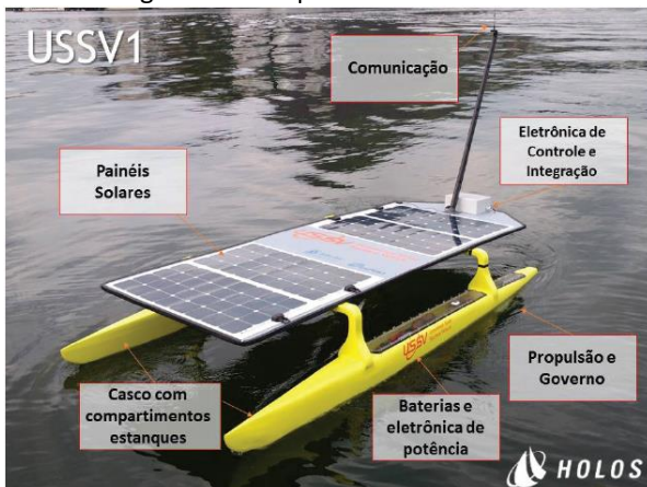
Figura 1 – Componentes do USSV1
