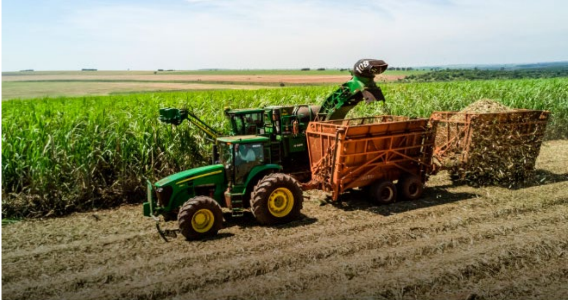
Figura 2 – Colheita e transbordamento mecanizado
