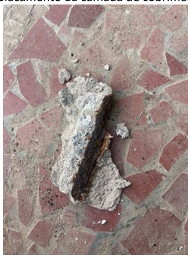
Figura 10 – Deslocamento da camada de cobrimento de concreto
