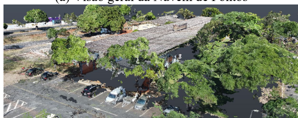
(b) Região sem processamento devido obstrução das árvores
