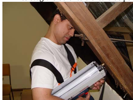
Figura 7 – Resistógrafo durante o ensaio de penetração
