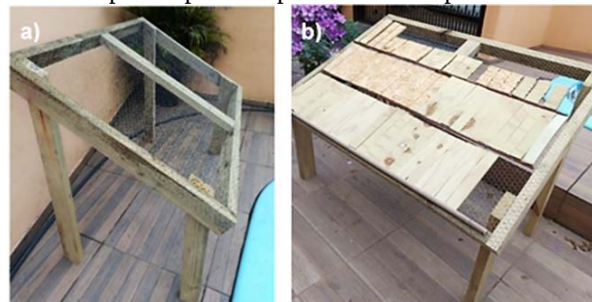
Figura 2 – Ensaio de Envelhecimento Natural (a) Bancada para ensaio de envelhecimento natural; (b) corpos de prova expostos ao intemperismo
