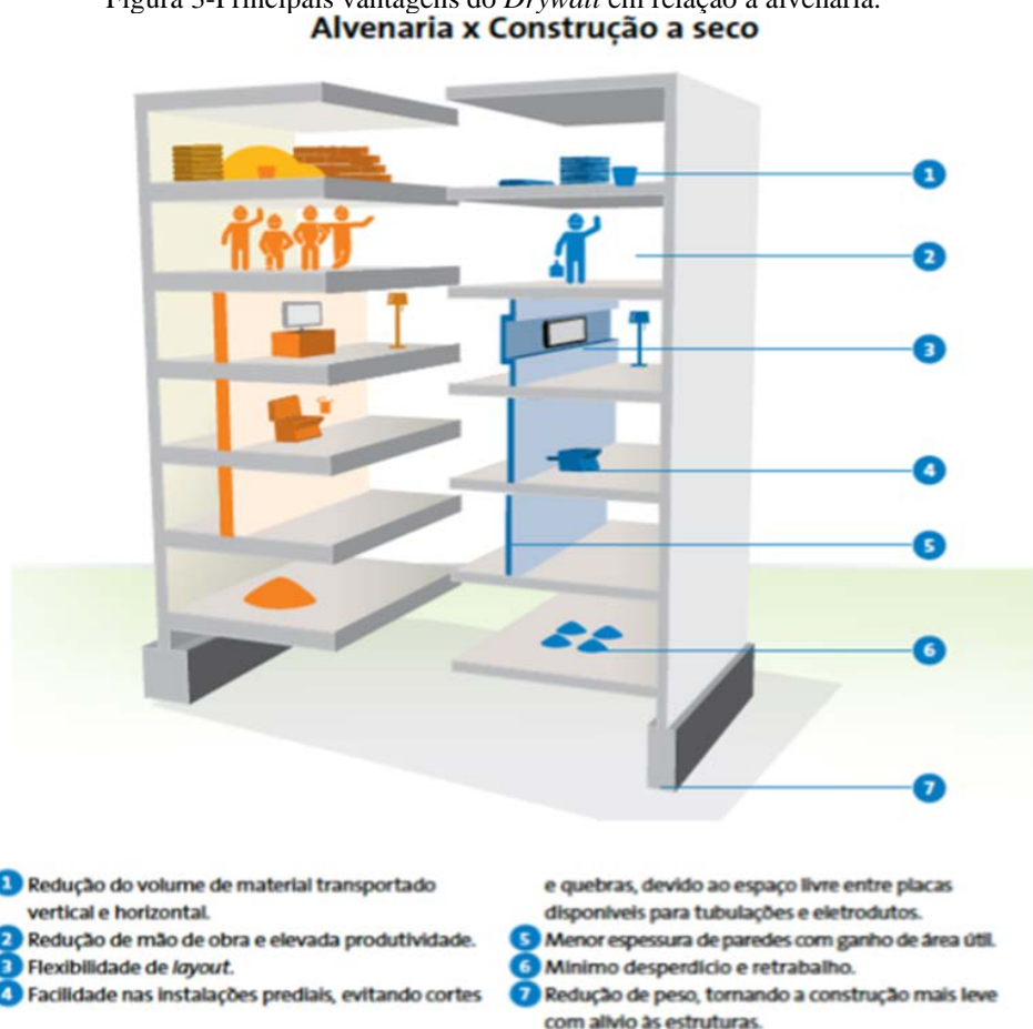
Figura 3-Principais vantagens do Drywall em relação a alvenaria.
