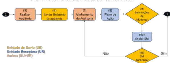
Figura 2 – Etapas 5-9b da Metodologia de transferência de método analítico.
