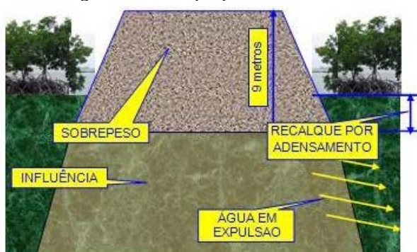
Figura 4 – Recalque por adensamento
