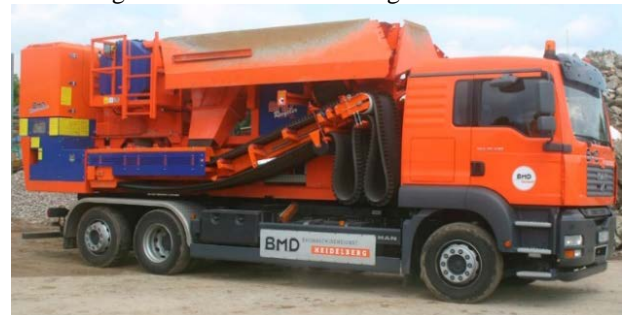
Figura 3 – Usina de Reciclagem de RCC
