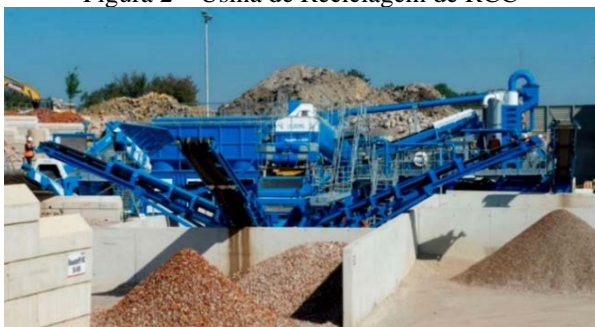
Figura 2 – Usina de Reciclagem de RCC
