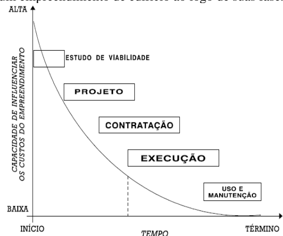
Figura 2- Capacidade de influenciar o custo final de um empreendimento de edifício ao longo de suas fases.
