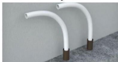
Figura 15 - Exemplo de tubulação passando pela laje
