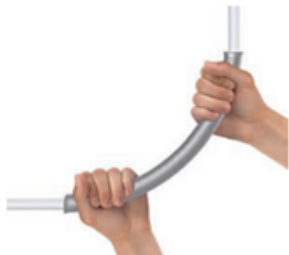
Figura 10 – Exemplo de execução de curvatura de tubo utilizando o curvador
