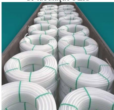
Figura 06 – Exemplo de Método armazenamento de tubulação PEX
