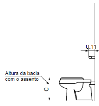
Figura 27 – Vista lateral da altura da barra de apoio.
