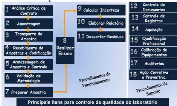
Figura 2 - Principais itens para controle de qualidade do laboratório
