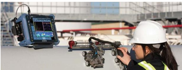
Figura 7 – Imagem de uma inspeção em tubos utilizando o conceito de ultrassom [6]
