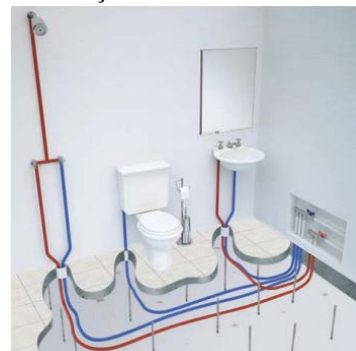
Figura 3 – Instalação do Sistema PEX Ponto a Ponto
