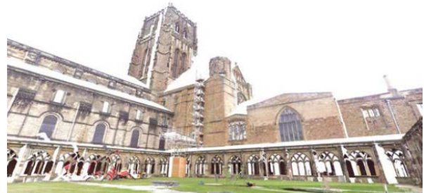
Figura 2 – Resultado da varredura laser da Catedral Durham
