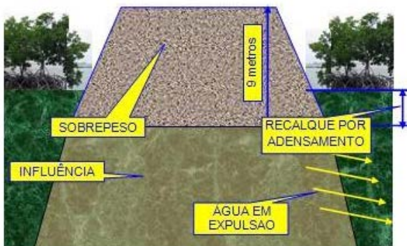
Figura 4 – Recalque por adensamento
