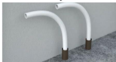
Figura 15 - Exemplo de tubulação passando pela laje
