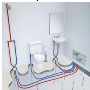
Figura 05 - Exemplo de instalação utilizando tubulações de PEX
