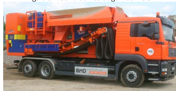
Figura 3 – Usina de Reciclagem de RCC
