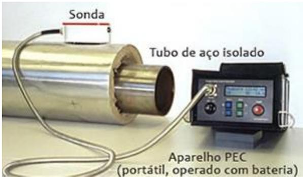
Figura 6 – Imagem ilustrativa do Ensaio de Correntes Parasitas em um tubo metálico [16]
