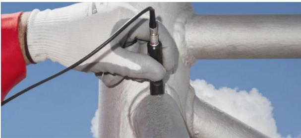
Figura 2 – Inspeção com uma sonda por correntes parasitas em uma estrutura metálica [5]
