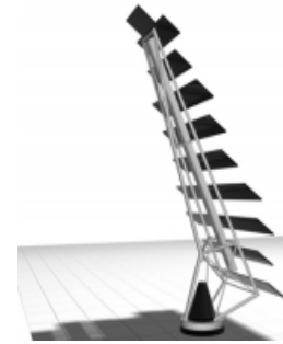
Figura 7 – Seguidor vertical ou de azimute
