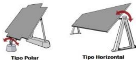
Figura 4 – Seguidor solar de eixo unico
