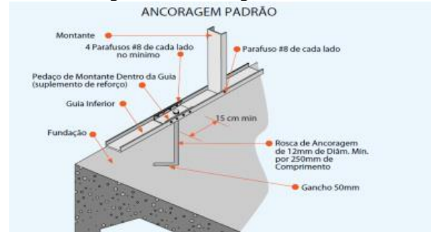
Figura 4 : Ancoragem de rosca
