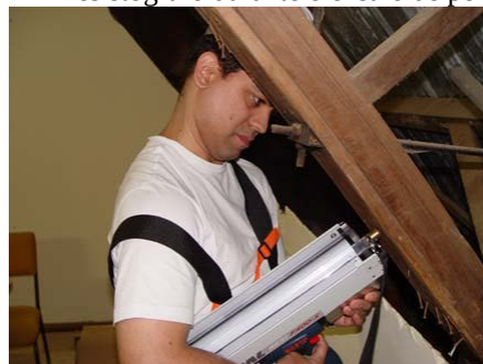
Figura 7 – Resistógrafo durante o ensaio de penetração
