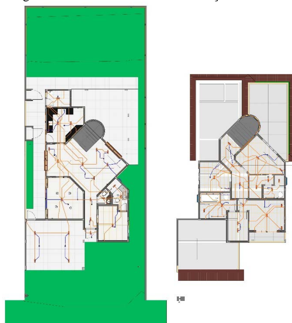
Figura 6 – Planta baixa com as tubulações elétricas.
