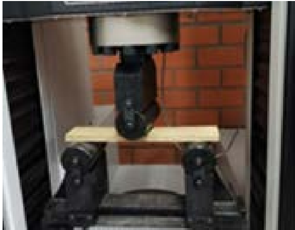
Figura 1 – Aplicação da carga para execução do ensaio de resistência à flexão
