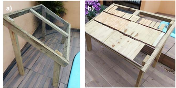
Figura 2 – Ensaio de Envelhecimento Natural (a) Bancada para ensaio de envelhecimento natural; (b) corpos de prova expostos ao intemperismo
