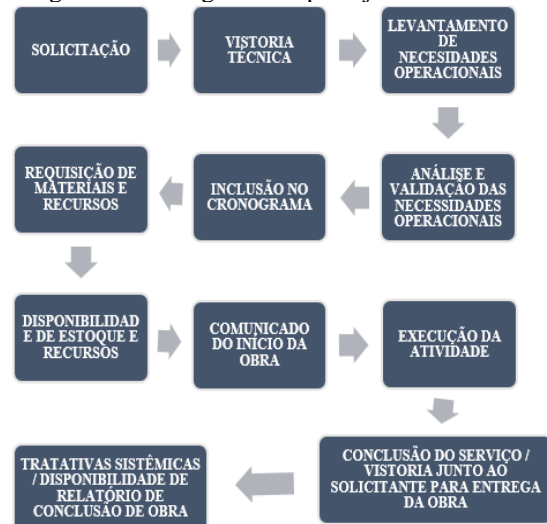
Figura 1 - Fluxograma de planejamento de obra
