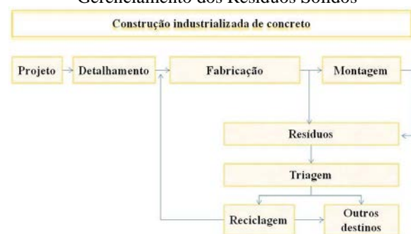
Figura 6 - Processo Circular da Construção Industrializada pela Aplicação de Plano de Gerenciamento dos Resíduos Sólidos
