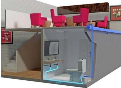
Figura 5 – Sistema de bombeamento em subsolo
