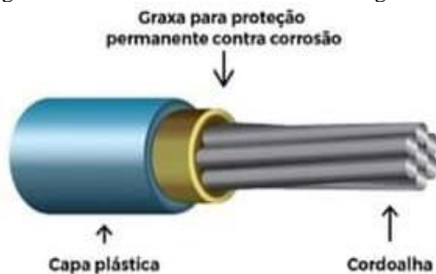
Figura 11: Detalhamento da cordoalha engraxada
